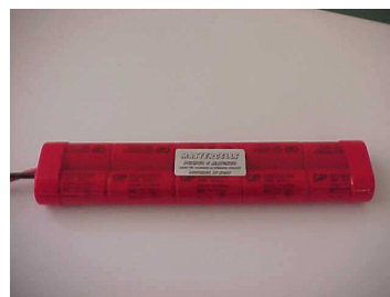
Akkus inline verlötet (Quelle: Fa. Hopf)
