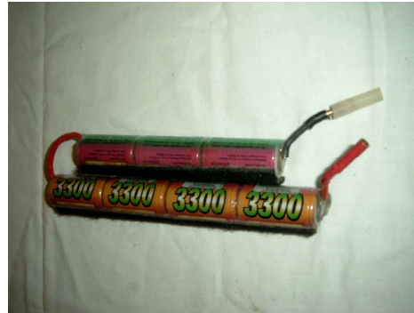
Akkustangen mit Blechverbindern ( Batt- Mann) Inline Pack 4 + 3
