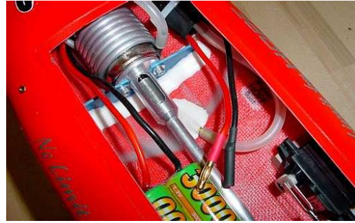
Motorspant im Boot eingeklebt; Motor weit vor der Stufe (Quelle www.hydroworld.de )
