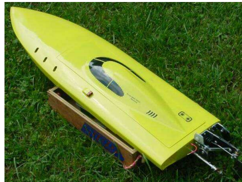
Entlüftungsöffnungen im Bugbereich (Quelle www.hydroworld.de )
