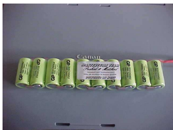
Akkus side by side verlötet
