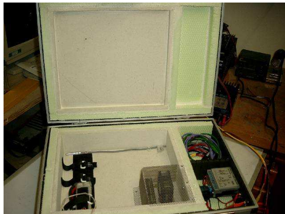
Lipo- Koffer, wärmedämmter Alukoffer mit Gipsfaserplatten ausgekleidet. Rechts die Temperatursteuerung, geschützt unter Draht ein Kermikelement als Wärmequelle
