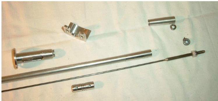
Alu- Motorspant; Kugellagerköcher mit Kugellager
