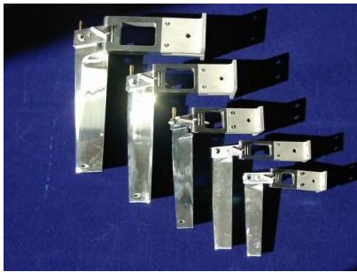
Ruderblätter mit Wassereinlass für Wasserkühlung (Quelle: Fa. Hydro & Marine)
