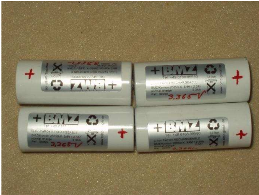
Falsch beschriftete Zellen und die Korrekturen in rot ( Quelle: Gerd Giese)
