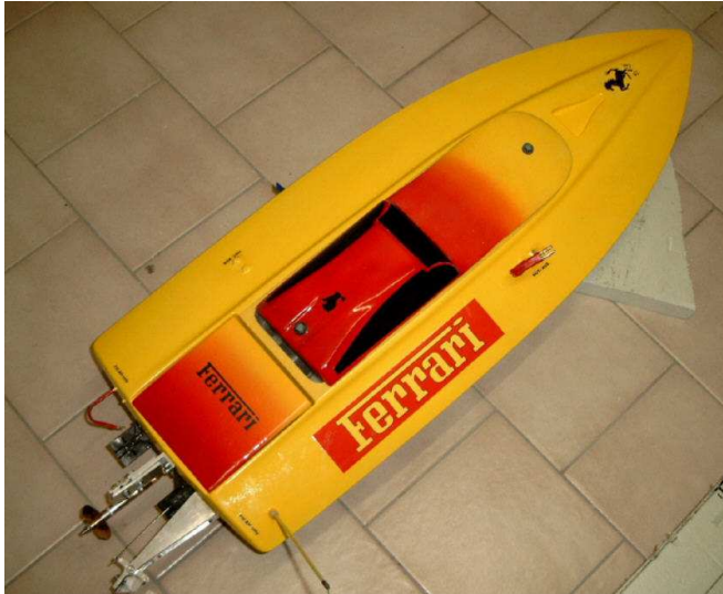
Größeres Mono Boot mit Trimmklappen nah am Stevenrohr
