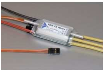
Bürstenlosregler, zum Teil auch schon zusätzlich mit einer Wasserkühlung ausgestattet ( Quelle: Internet)
