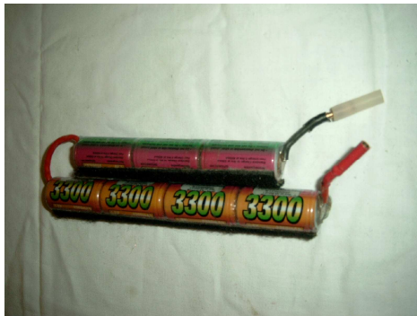
4+3 Sticks, der 4 mm Gold-Stecker an Minus mit einem Stück Silikonschlauch gegen Kurzschluss gesichert
