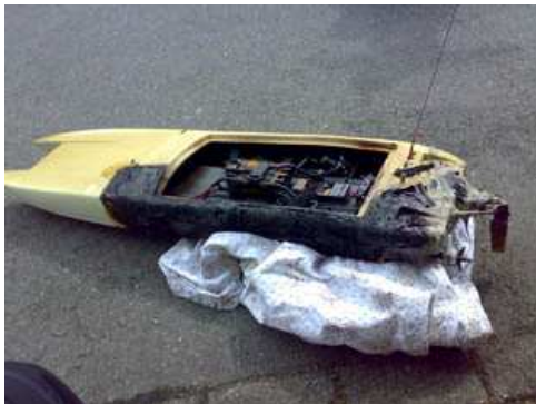
Schäden durch überlastete Regler ( Quelle Internet)
