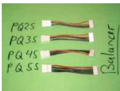
Kabelsatz ( 2S bis 5S) zum Anschluss von Lipos eines Herstellers an einen Balancer
