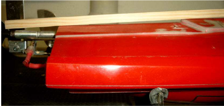
2mm Luft unter der Welle am Propeller bzw. Lagerköcher (Richtlatte= Tischplatte)
