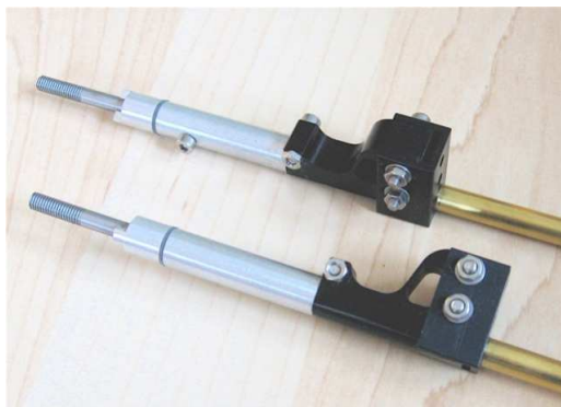
Powertrimms mit dog drive System;
