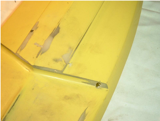
Entlüftung des Flutkanals im Stufenbereich
