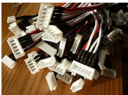
Balancer- Kabel : Buchsen und Stecker versch. Größen zum Erstellen von Adapterkabeln
