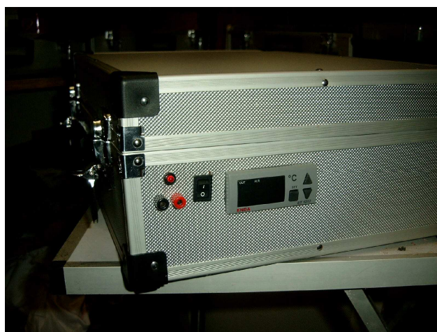
Die Steuereinheit, 12V Anschluss, Schalter und Kontroll- Leuchte am Lipokoffer
