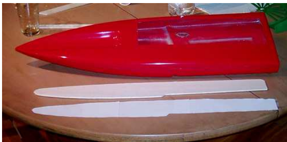
Flutkanalschablone und das fertige Abschott- Bauteil (Quelle www.hydroworld.de )
