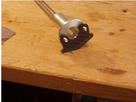
Motorspant an Wellenanlage angepasst, sollte aber nicht motorseitig eingebaut werden
