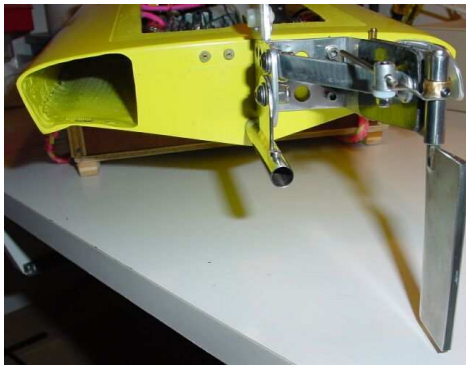
Flutkanalöffnung im Heckspant (Quelle www.hydroworld.de )
