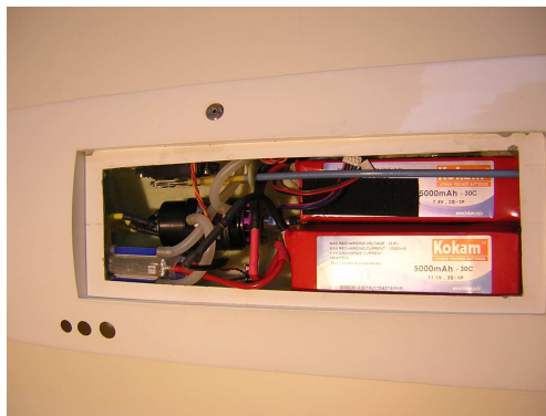
5000er 30C Lipo- Packs in einem Mono- Boot
